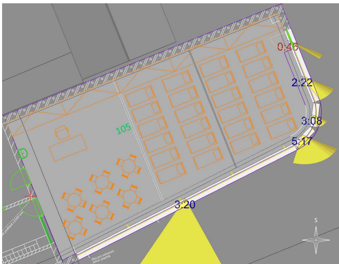
Obr. 4: Výpočetní 3D model se zobrazením výpočtem stanovené doby proslunění pro hodnocenou místnost dne 21. března při výšce slunce nad horizontem minimálně 13^\circ (formát času [H:MM])
