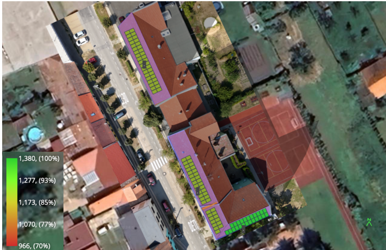
Obrázek č. 1.2.21: Schéma efektivity výroby elektřiny FV panelů – ZŠ Jana Noháče
