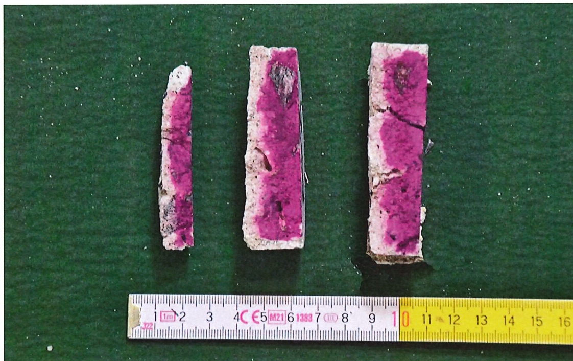
Obr. 2 Zkušební vzorky po fenolftaleinovém testu hloubky karbonatace, která u všech těles dosáhla pouze cca 6-7 mm.
