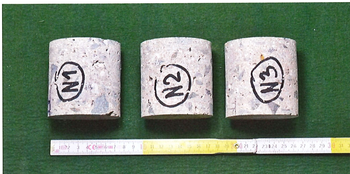
Obr. 3 Zkušební tělesa 1:1 vyrobená ze vzorků betonu N 1, N 2 a N 3.
