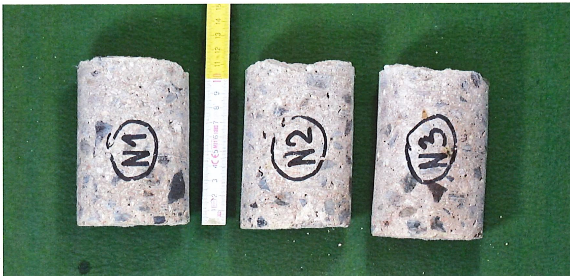
Obr. 1: Zkušební vzorky N 1 až N 3 ze stropních panelů pod 1. NP objektu. Beton obyčejný hutný, kamenivo max. do 20 mm, pórovitost mírná.
